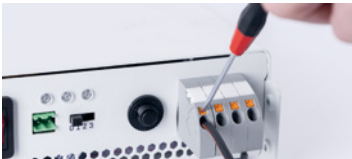
Ausgangsklemmen 36 V (2,5 mm 2 – 6,0 mm 2 )
