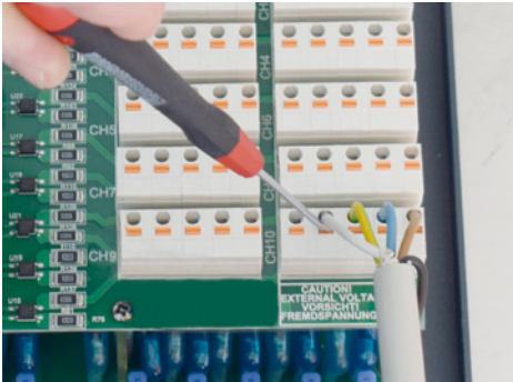
Raumthermostat anschließen, Kabel 5x1,5 mm 2
